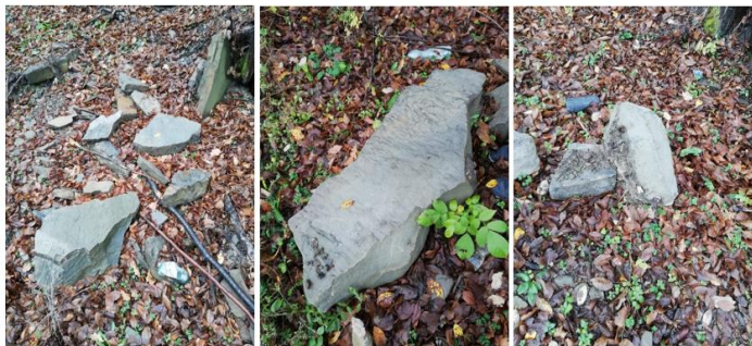
Rysunek 25. a b, c Odłamki skalne znajdujące się pod analizowaną skarpią, tak zwane „silent witness” [fot. W. Błaszczyk]
