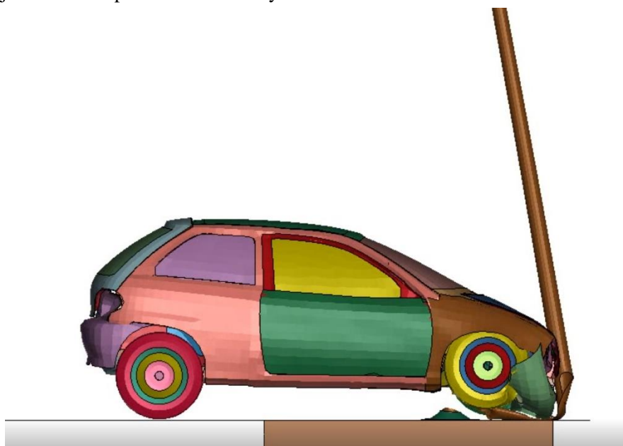
Rysunek 17. Wizualizacja zachowania się słupa w chwili zderzenia dla materiału o zwiększonej plastyczności
