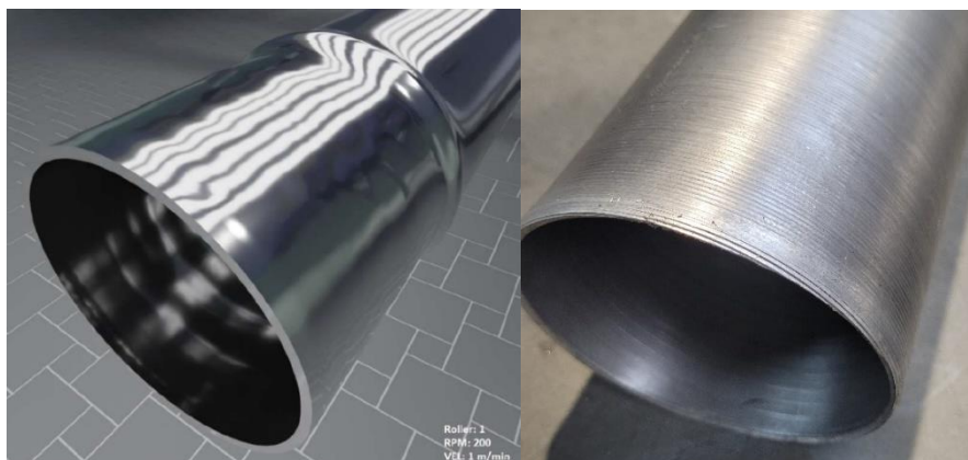
Rysunek 13. Powierzchnia wyrobu po zgniataniu obrotowym dla posuwu 200 obr./min [7]
