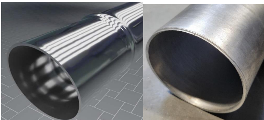
Rysunek 14. Powierzchnia wyrobu po zgniataniu obrotowym dla posuwu 600 obr./min [7]
