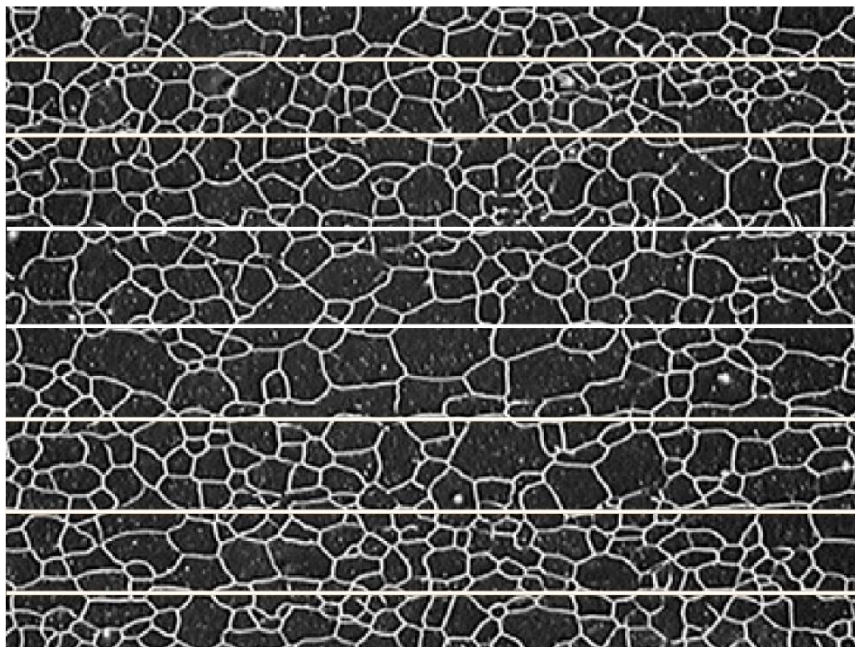
Rysunek 13. Obraz mikroskopowy struktury na zglądzie metalograficznym przecięty liniami testowymi [opracowanie własne]
