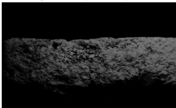
Rysunek 2. Próbkę destruktu z widocznymi wtrąceniami smoły w przekroju [15]
