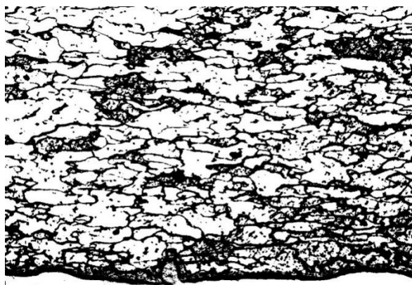
Rysunek 11. Obraz poddany segmentacji z wykorzystaniem algorytmu samouczącego WEKA [opracowanie własne]
