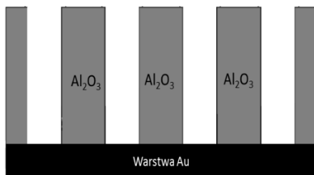
Rysunek 2. Schemat ilustrowujący przekrój poprzeczny membrany porowatego tlenku glinu – opracowanie własne
